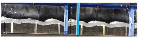
Bild 7. Wasserspiegellagen bei Klarwasserabfluss mit  $q = 8.9 \, \text{m}^3/(\text{ms})$  und Kornmischung 1 a) Wechselsprünge mit eingetauchtem Strahl bei  $J_B = 5 \, \%$ ,  $L_T = 20 \, \text{m}$ , b) stehende Wellen bei bei  $J_B = 3 \, \%$ ,  $L_T = 15 \, \text{m}$ .
