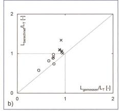
Bild 6. (a) Vergleich der in den Versuchen gemessenen Antidünenlängen mit den berechneten Antidünenlängen nach dem Ansatz von Recking et al. (2009); b) Vergleich der dimensionslosen gemessenen Antidünenlängen  $L_{\rm gemessen}/L_{\rm T}$  mit dem Verhältnis  $L_{\rm berechnet}/L_{\rm T}$  (o stabile Abflussverhältnisse an Antidünen, x in sich zusammenfallende Antidünen mit instationären Wellen).
