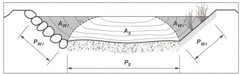
Bild 5. Querschnittszerlegung zur Berücksichtigung des Wandeinflusses bei kompakten Gerinnequerschnitten, mit AWI,r = linke respektive rechte Wandeinflussfäche, PWI,r = benetzter Umfang der linken respektive rechten Wandeinflussfläche (Bezzola, 2016).
