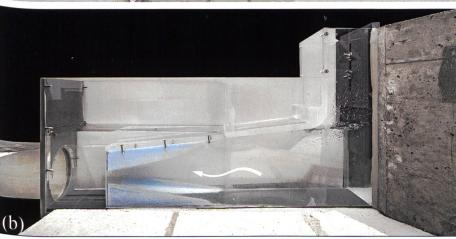
Bild 7. (a) Ansicht Einlaufbauwerk und (b) Längenschnitt Stollen im hydraulischen Modell (Massstab 1:40).
