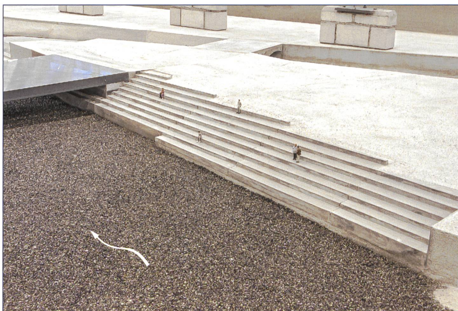
Bild 12. Sitzstufen bei Sigi-Feigel-Terrasse im hydraulischen Modell (Massstab 1:30).
