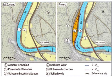
Bild 3. Ursprünglicher Verlauf der Sihl am Standort Rütiboden sowie Projektübersicht des Schwemmholzrückhalts (Schmocker et al., 2014).
