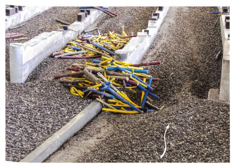
Bild 13. Schwemmholzablagerungen vor Sihldurchlässen im hydraulischen Modell (Massstab 1:30).
