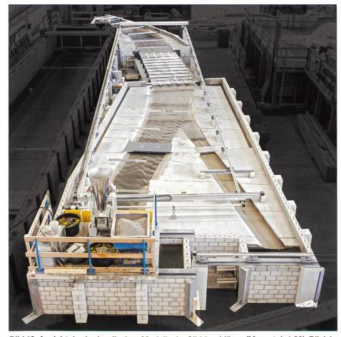
Bild 10. Ansicht des hydraulischen Modells der Sihldurchlässe (Massstab 1:30), Blick in Fliessrichtung.
