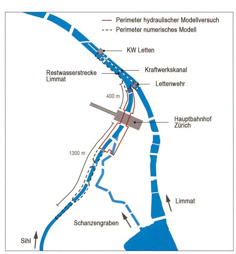
Bild 9. Untersuchungsgebiet Modellversuch Sihldurchlässe HB Zürich.
