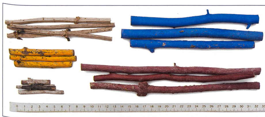
Bild 4. Modellschwemmholz in 5 Klassen (Massstab 1:40).
