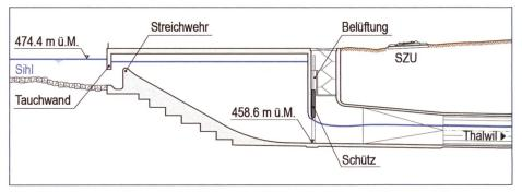
Bild 5. Längenschnitt des Einlaufbauwerks (Planskizze Vorprojektierung IUB, Januar 2011).
