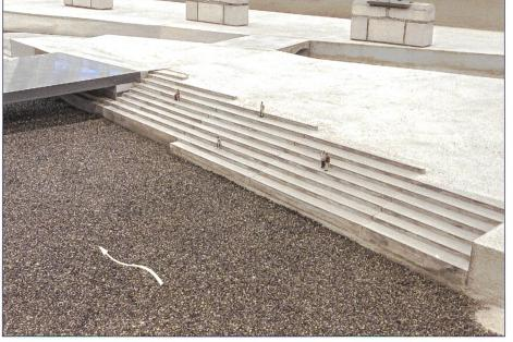
Bild 12. Sitzstufen bei Sigi-Feigel-Terrasse im hydraulischen Modell (Massstab 1:30).
