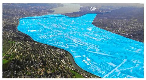
Bild 4. Weil grosse Teile von Zürich auf dem natürlichen Schwemmkegel der Sihl liegen, würde links austretendes Sihlwasser durch die Stadt der Limmat zufliessen. Die Schäden wären enorm (Foto: H. J. Egger, Uster).
