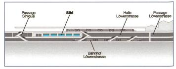
Bild 3. Die Hochwassersituation beim Hauptbahnhof Zürich ist sehr kritisch. Die unterirdischen Passagen, Bahnhöfe und Tunnels könnten überflutet werden.
