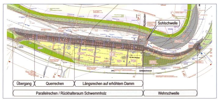
Bild 11. Situation des Sihl-Schwemmholzrechens: Die Höhen der Sohlschwelle und der Wehrschwelle sind mit einem hydraulischen Modellversuch bestimmt worden. Diese Höhen bestimmen massgebend die Funktion des Schwemmholzrückhalts.
