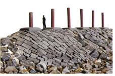
Bild 14. Modell des Landschaftsarchitekten im Massstab 1: 50 als Vorlage für die Bauausführung: Übergang Wehrschwelle – Längsdamm, leicht vorstehende Köcherfundamente.
