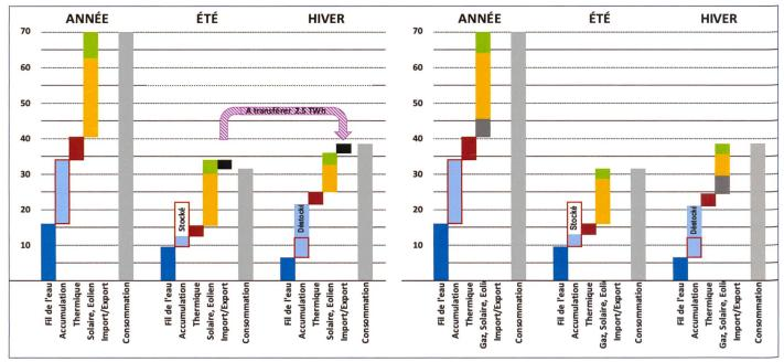
Figure 4. Productions et consommation d'électricité annuelles et saisonnières en Suisse en 2050, en TWh, incluant les changements induits par la transition énergétique et les changements climatiques, pour les scénarios «import/export saisonnier» (gauche) et «production hivernale» (droite).
