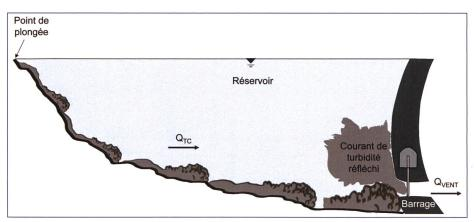
Figure 2. Courant de turbidité en progression sur le fond du réservoir et projection de son transit à travers la vidange de fond.
