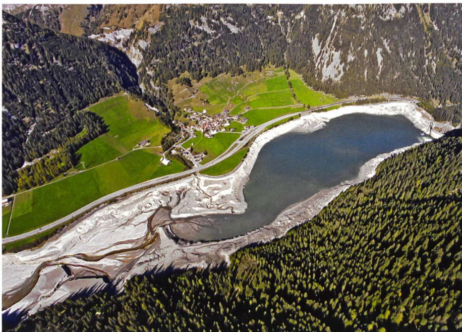
Figure 1. Sédimentation du réservoir de Sufers aux Grisons, Suisse (photo obtenue avec l'aimable autorisation de Kraftwerke Hinterrhein AG).
