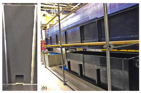
Figure 3. (a) le mur aval et l'orifice rectangulaire ; (b) l'intégralité du canal (photo prise du côté amont) et le bac utilisé pour le mélange.
