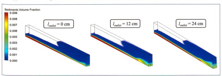
Figure 5. Les contours de concentrations obtenus avec l'orifice placé à différents niveaux verticaux après t = 225 s du début du transit (correspondant à plus ou moins 3 heures en prototype).
