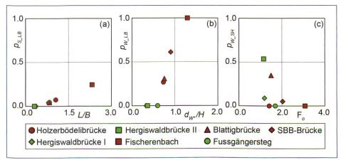
Bild 5. Verklausungswahrscheinlichkeiten (a)  $p_{S\_LB}$  für einzelne Stämme nach Lange und Bezzola (2006), (b)  $p_{W\_LB}$  für einzelne Wurzelstöcke (Index W) nach Lange und Bezzola (2006) und (c)  $p_{W\_SH}$  nach Schmocker und Hager (2011); Brücken mit einer hohen Verklausungsgefahr sind in Rot dargestellt.
