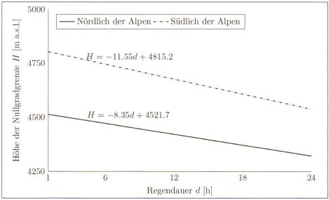
Bild 2. Lineare Interpolation der maximal gemessenen Höhe der Nullgradgrenze abhängend von der Regendauer.
