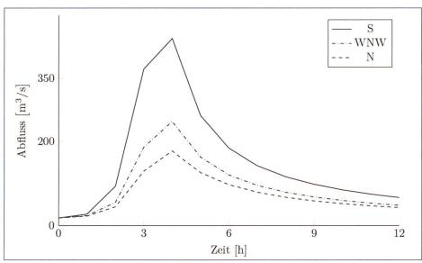
Bild 7. Bestimmung des kritischen Windsektors für die PMP-PMF-Simulationen, beruhend auf einem dreistündigen PMP-Ereignis.
