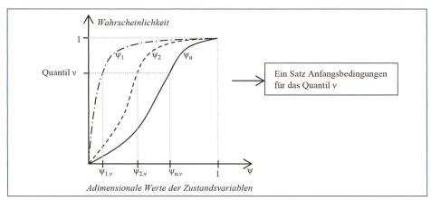
Bild 3. Deterministisches Vorgehen bei der Bestimmung einer Kombination von Anfangsbedingungen für die Simulation, beruhend auf den empirischen Wahrscheinlichkeitsfunktionen.
