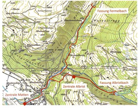
Bild 1. Geografische Lage der beiden Fassungen, Zentralen und der Druckleitung.
