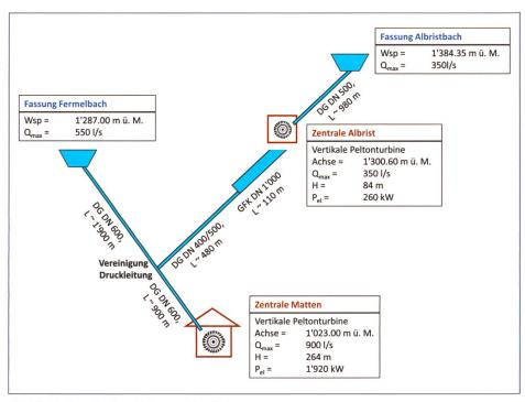
Bild 2. Hydraulisches Schema der Anlage.
