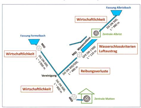
Bild 16. Massgebende Kriterien für die Bestimmung der Durchmesser der Druckleitungen.
