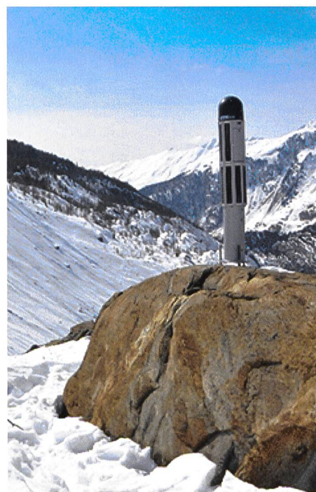
Neu entwickeltes GPS-Messgerät der ETHZ, Institut für Geodäsie und Fotogrammetrie IGP (Quelle: BAFU).
