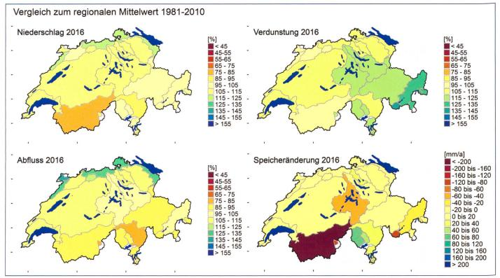
Bild 2. Wasserbilanzkomponenten der Grosseinzugsgebiete. Prozentuale Abweichungen 2016 gegenüber der Normperiode 1981–2010 für den mittleren Niederschlag (o.l.), die mittlere Verdunstung (o.r.) und den mittleren Abfluss (u.l.) sowie die absolute Speicheränderung 2016 gegenüber 2015 in mm (u.r.).
