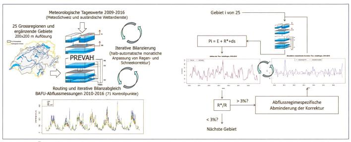
Bild 3. Links: Übersicht der Konfiguration von PREVAH für die jährliche Fortführung der Modellrechnungen zum Wasserhaushalt der Schweiz. Gegenüber Bild 2 wurden zusätzliche Einzugsgebiete berücksichtigt. Rechts: Schema zur iterativen Bilanzierung. Modellparameter, welche das Niederschlagsvolumen beeinflussen, wurden für jede Grossregion auf Monatsbasis angepasst, um eine verbesserte Bilanzierung der 71 Kontrollgebiete zu erzielen. Siehe Text für weiterführende Informationen.
