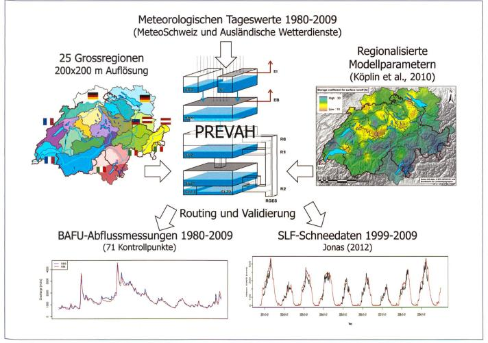
Bild 2. Übersicht der Konfiguration des hydrologischen Modells PREVAH für die CCHYDRO-Berechnungen (BAFU, 2012). Für die Ermittlung des Wasserhaushalts an jedem der 200 × 200-m-Gitterpunkte der hydrologischen Schweiz wurden tägliche meteorologische Daten als Antrieb für die Periode 1980–2009 verwendet. Siehe Abschnitt 2 von Bernhard und Zappa (2012) für weiterführende Informationen.
