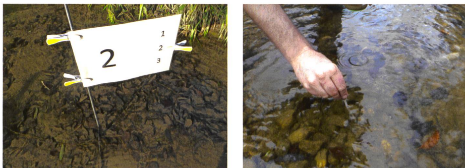
Bild 4. Systematische Beprobung, Kennzeichnung und Dokumentation der Probenstellen. Je nach Fragestellung werden mehrmals Wasserproben analysiert oder gezielt Substrate entnommen.
