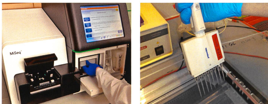
Bild 2. HTS-Plattform Illumina MiSeq. Pipettiervorgang, ein typischer Arbeitsschritt.
