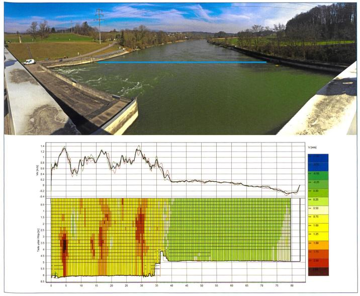
Bild 4. Messquerschnitt und Konturplot der absoluten mittleren Fliessgeschwindigkeiten unterstrom des Kraftwerks Bannwil an der Aare.
