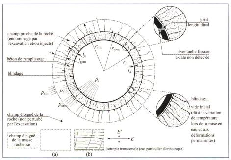
Figure 1. Schéma de la section transversale d'une galerie ou puits blindé dans (a) une roche isotrope, et (b) dans une roche transversalement isotrope avec deux familles de discontinuités.
