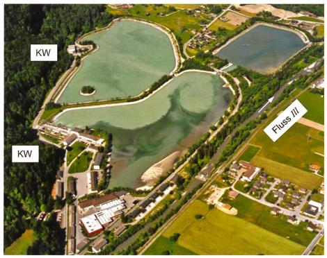
Bild 4. Ausgleichsbecken Rodund in Österreich (Vorarlberg) mit Eintrag von Gletscherschliff durch die Oberliegerkraftwerke und von teils gröberen Sedimenten durch die Wasserfassung an der III (Sollerer und Matt 2013).
