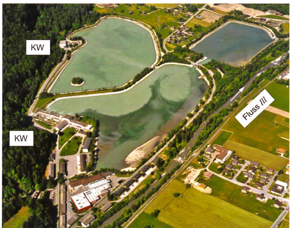
Bild 4. Ausgleichsbecken Rodund in Österreich (Vorarlberg) mit Eintrag von Gletscherschliff durch die Oberliegerkraftwerke und von teils größeren Sedimenten durch die Wasserfassung an der Ill (Sollerer und Matt 2013).
