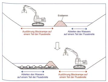
Bild 5. Aufschütten eines Erddamms in der Mitte des Gerinnes. Das Wasser wird auf einem Teil der Flussbreite abgeleitet. Die Blockrampe wird in zwei Etappen ausgeführt.
