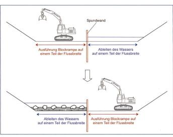
Bild 6. Einbringen einer Spundwand. Das Wasser wird auf einem Teil der Flussbreite abgeleitet. Die Blockrampe wird in zwei Etappen ausgeführt.
