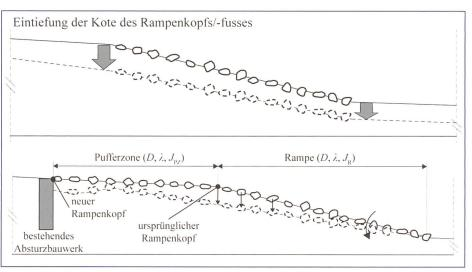
Bild 4. Wichtige Prozesse zur Betrachtung des Systems «Rampe+Fluss», die im Dimensionierungskonzept einer UBR zu berücksichtigen sind. Oben: Eintiefung der Kote des Rampenkopfs/-fusses. Unten: Prinzipskizze der Funktion der Pufferzone (der gezeigte neue Rampenkopf entspricht der Situation nach der vollständigen Inanspruchnahme der Pufferzone).
