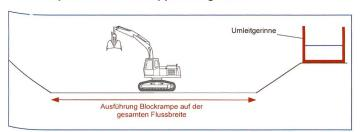
Bild 7. Ableitung des Wassers in einem Umleitgerinne.
