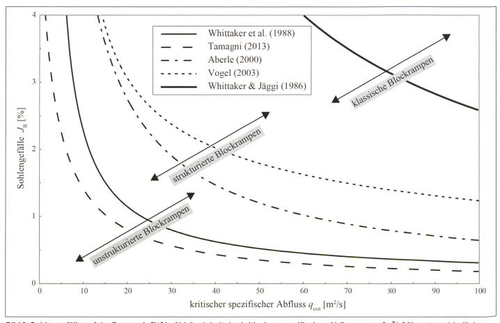
Bild 3. Sohlengefälle auf der Rampe  $J_R$  [%] in Abhängigkeit des kritischen spezifischen Abflusses  $q_{crit}$  [ $m^2/s$ ] für unterschiedliche Blockrampentypen bzw. Ansätze mit konstantem Blockdurchmesser D = 1.3 m ( $\lambda = 0.15$  für Tamagni (2013) und  $\lambda = 0.67$  für Vogel (2003), wobei  $\lambda = 0.67$  der minimal untersuchten Belegungsdichte entspricht).
