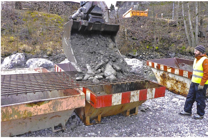
Bild 8. Siebanalyse des Untergrundmaterials (Simme, Bäuerle, Aussieben der groben Komponenten).
