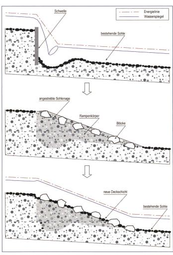
Bild 1. Schematische Darstellung des Anfangszustands (oben), des Zustands nach Ausführung (Mitte) und des Endzustands (unten) einer aufgelösten unstrukturierten Blockrampe.
