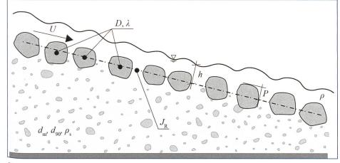
Bild 2. Schematischer Längsschnitt durch eine UBR mit den massgebenden Parametern.
