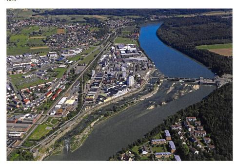
Bild 2b. Kraftwerk Rheinfelden mit Umgehungsgewässer (links) und Vertical-Slot-Fischpass (rechte Uferseite); Foto: Energiedienst.
