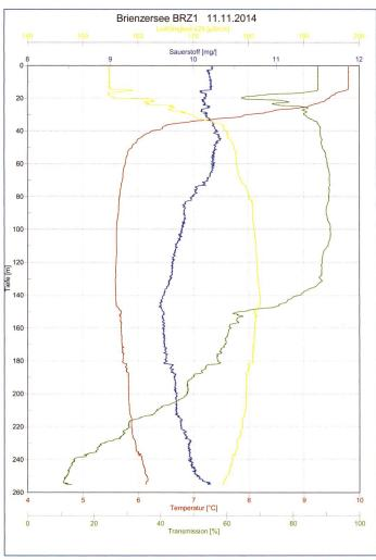
Bild 6. Tiefenprofil vom 11. November 2014 von Leitfähigkeit, Sauerstoff, Wassertemperatur und Transmission im Brienzersee (in der Nähe der Einmündung der Aare in den Brienzersee, aus GBL 2014). Bemerkung: Die Einlagerung der Schwebstoffe erfolgte gemäss Grafik unterhalb von 130 m Wassertiefe (vgl. grüne Linie für Transmission).
