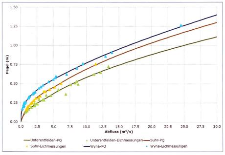
Bild 3. Eichmessungen und zugehörige PQ-Beziehungen der Messstationen.
