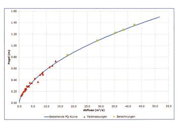
Bild 9. Messstation Unterentfelden, Eichmessungen, bestehende PQ-Beziehung und Berechnungen.
