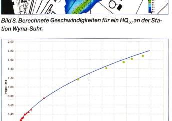
Bild 10. Messstation Suhr, Eichmessungen, bestehende PQ-Beziehung und Berechnungen.
