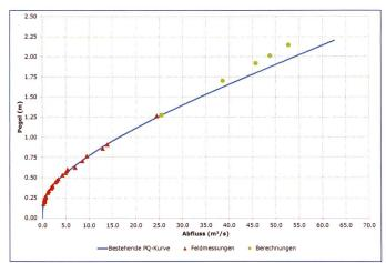
Bild 11. Messstation Wyna, Eichmessungen, bestehende PQ-Beziehung und Berechnungen.
