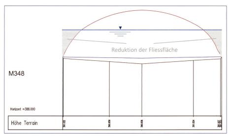
Bild 6. Reduktion der Fliessfläche durch die Bogenbrücke.
