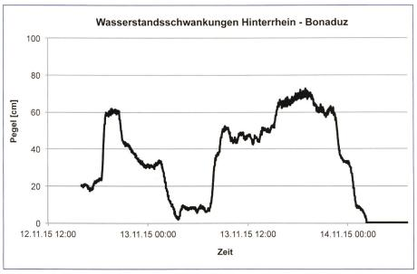
Bild 10. Wasserstandschwankungen im Hinterrhein während des Flachnetzversuches (aufgezeichnet mit Drucksonde Orpheus Mini, Messintervall 1 Minute). Die Netze wurden am 12. November 2015 exponiert und nach einem 33-stündigen Schwall am 14. November 2015 wieder geborgen.
