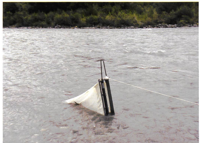
Bild 4. Messeinrichtung Feldversuche (links: überströmtes Flachnetz bei Schwall, rechts: Driftnetz bei Schwallanstieg).
