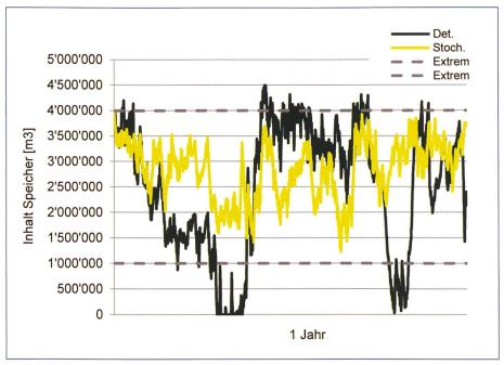
Bild 7. Vorsichtigere Speicherfahrweise in der stochastischen Optimierung im Vergleich zur deterministischen Optimierung.
