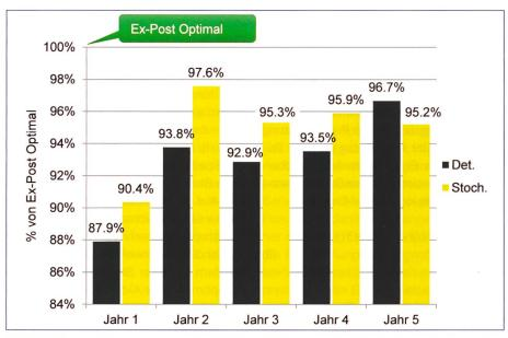
Bild 5. Höherer Ertrag in der stochastischen Optimierung im Vergleich zur deterministischen Optimierung für typischen Speicherkraftwerk.
