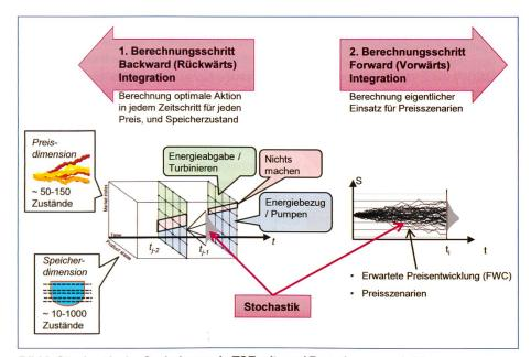
Bild 3. Stochastische Optimierung in TSE mit zwei Berechnungsschritten.
