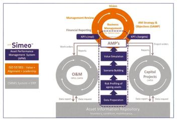
Bild 3. Asset-Management-System nach ISO 55001 mit einem APM-Entscheidungsprozess.
