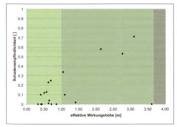
Bild 7. Schadenempfindlichkeit vs. effektive Wirkungshöhe mit sichtbarer Streuung der Datenpunkte zwischen 0.50 und 1 m. Ein Trend zu ansteigender Schadenempfindlichkeit bei steigender Prozessintensität ist in den Daten erkennbar. Die schadenbasierten Intensitätsklassen sind in hellgrün (schwach), grün (mittel) und graugrün (stark) markiert.
