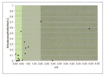
Bild 8. Schadenempfindlichkeit vs. Prozessintensität v\*h, wobei kein deutlicher Trend auszumachen ist. Die Intensitätsklassen nach Loat & Petraschek (1997) sind in hellgrün (schwach), grün (mittel) und graugrün (stark) markiert.
