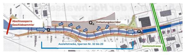
Bild 2. Ausleitstrecke gemäss Hochwasserschutzprojekt. Q = Abfluss oberhalb der Ausleitstrecke, Qa = Ausleitwassermenge und Qb = Abfluss unterhalb der Ausleitstrecke.
