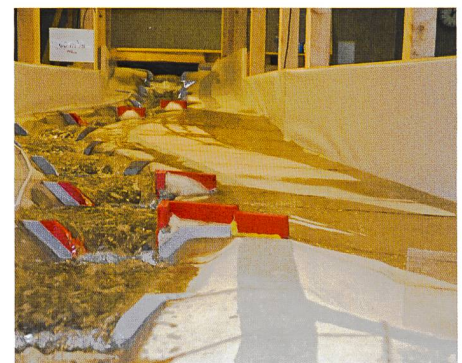
Bild 6. Beginn der Ausleitung bei den Sperren Nr. 22 und Nr. 23 (Vordergrund) sowie Nr. 27 und Nr. 28 (Hintergrund) im hydraulischen Modellversuch beim Dimensionierungsabfluss von 60 \text{ m}^3/\text{s} . Blick bachaufwärts.
