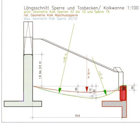
Bild 7. Vergleich der Kolkbecken-Geometrien, grüne Linie: OK Blöcke Kolkwannen Ausleitstrecke und Sperre 19, teilweise stabil; rot: OK Blöcke Kolkwanne Abschlusssperre, nicht stabil; blau: OK Blöcke Kolkwanne Sperre 34, nicht stabil.
