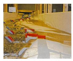
Bild 6. Beginn der Ausleitung bei den Sperren Nr. 22 und Nr. 23 (Vordergrund) sowie Nr. 27 und Nr. 28 (Hintergrund) im hydraulischen Modellversuch beim Dimensionierungsabfluss von 60 m³/s. Blick bachaufwärts.
