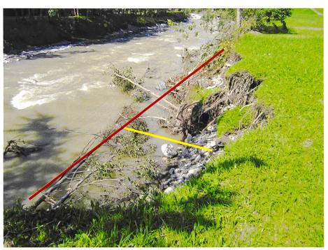
Bild 5. Vermessung der Böschungserosion: die rote Linie bezeichnet die Länge, die gelbe Linie die Breite der betroffenen Fläche (aus Zurbrügg 2015).
