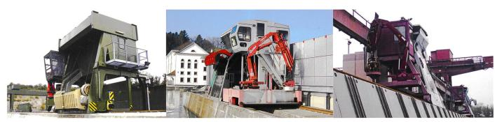
Bild 3. Vergleich zwischen einer ungünstigen (links, Baujahr 2009) und zwei gut konstruierten Maschinenvorderseiten (Mitte Baujahr 1995 und rechts Baujahr 1991) in Bezug auf die Gebrauchstauglichkeit.
