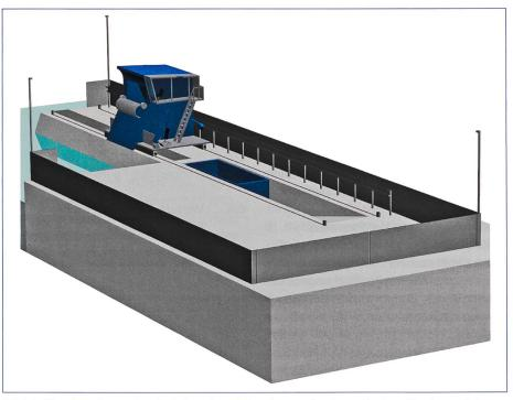
Bild 4. Abschrankung des Gefahrenbereichs einer vollautomatischen Rechenreinigungsmaschine.
