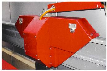
Bild 5. Messwagen für die absolute Wegmessung inkl. Endlagenüberwachung.
