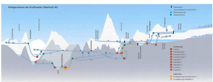
Bild 1. Anlagenschema mit Ausbauvorhaben «Tandem».
