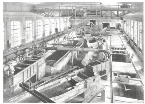
Bild 7. VAW-Versuchshalle rechts mit grossem Versuchskanal (Braeckman 1933, Anonym 1935).
