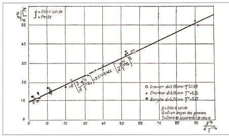
Bild 5. Einfluss der Sedimentdichte auf Sedimenttransport nach Favre (1935).
