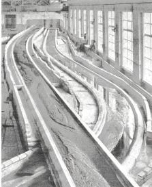
Bild 10. Rheinmodelle im VAW-Laboratorium (Müller 1953).
