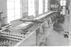
Bild 4. VAW-Sedimenttransport-Kanäle (a) grosser, (b) kleiner Kanal (Favre 1935).
