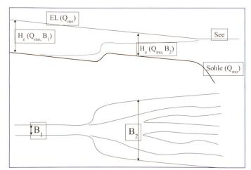
Bild 6. Versatz in der Aufweitung, Mündungswall im Delta.
