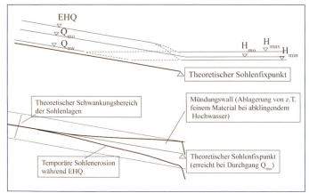
Bild 5. Mündungsdynamik in einer prismatischen Kanalmündung.
