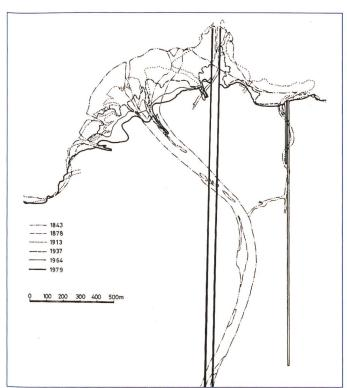
Bild 1. Begradigung der Reuss durch die Korrektion von 1854 mit Durchstich zu einer neuen Mündung. Vorstoss der neuen Mündung einerseits und Uferrückgang im Bereich des alten Deltas als Folge von Mangel an Schwebstoffen und Baggerungen.
