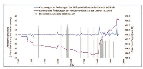
Bild 3. Bewertung der flussbaulichen Veränderungen der Zu- und Abflussverhältnisse der Limmat: +/- 1 keine bis kaum verschlechterte (-) / verbesserte (+) Zu- bzw. Abflusswirkung +/- 6 sehr stark verschlechterte (-) / verbesserte (+) Zu- bzw. Abflusswirkung.
