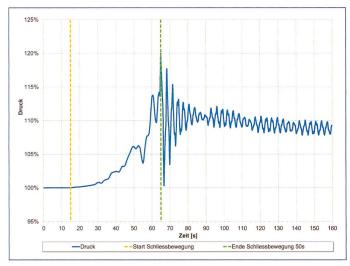
Diagramm 2. Verlauf des Drucks bergseits des Kugelschiebers.
