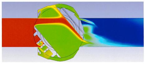
Bild 2. Visualisierung der Strömung durch den Kugelschieber.
