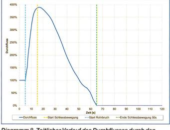
Diagramm 8. Zeitlicher Verlauf des Durchflusses durch den Kugelschieber im Rohrbruchfall.
