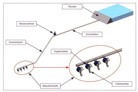
Bild 1. Kraftwerkslayout komplett.
