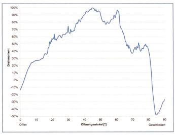
Diagramm 4. Drehmomentverlauf am Drehkörper beim Schliessen mit vollem Turbinendurchfluss.
