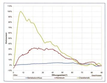
Diagramm 11. Vergleich zwischen Charakteristik, Betriebsdurchfluss und Rohrbruchfall.
