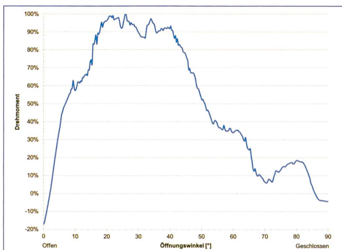
Diagramm 9. Drehmomentverlauf am Drehkörper beim Schliessen im Rohrbruchfall.
