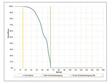
Diagramm 3. Verlauf des Durchflusses durch den Kugelschieber.
