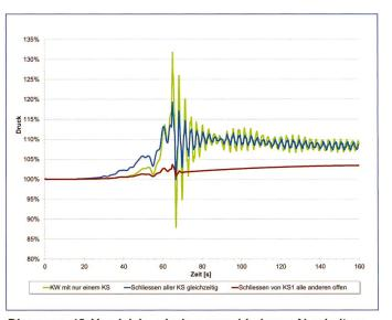
Diagramm 12. Vergleich zwischen verschiedenen Abschaltvorgängen bei Betriebsdurchfluss.
