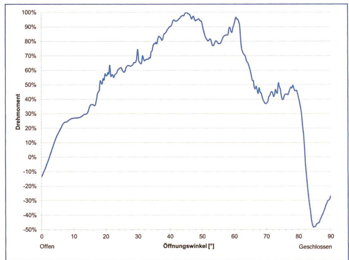
Diagramm 4. Drehmomentverlauf am Drehkörper beim Schliessen mit vollem Turbinendurchfluss.
