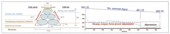
Figure 11. Concept de digue retenu et bathymétrie du lac au droit de la digue projetée.
