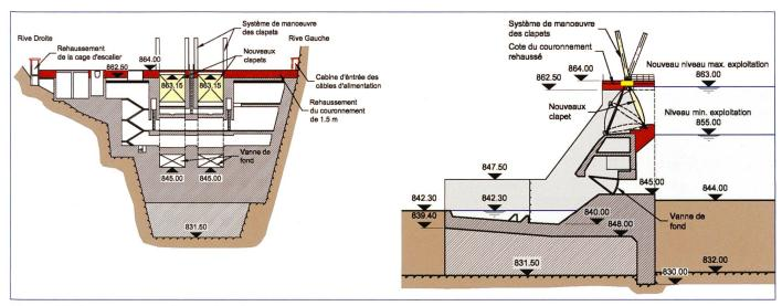
Figure 7. Solution constructive envisagée.
