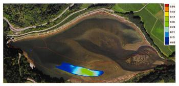
Figure 10. Contrainte de cisaillement et dépôts pour une crue annuelle (100 m³/s avec le lac à 860 m s.m.).
