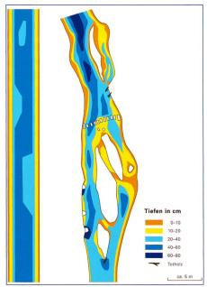
Bild 1. Mit der Revitalisierung sind nicht nur die Uferlinien vielfältiger geworden, sondern auch Fliessgeschwindigkeiten und Wassertiefen (hier schematisch dargestellt).
