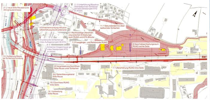
Bild 4. Geschiebesammler am Schächenkanal mit seitlichem Streichwehr und Massnahmen im Bereich der Schächenmündung.
