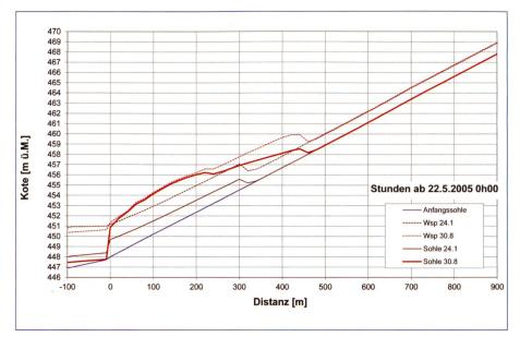
Bild 3. Wasserspiegel und Sohlenlagen gemäss Simulation zum Zeitpunkt des Ausuferns in die «Stille Reuss» (24.1) und ins RUAG-Areal (30.8). Die Uferhöhen betragen 3 m.
