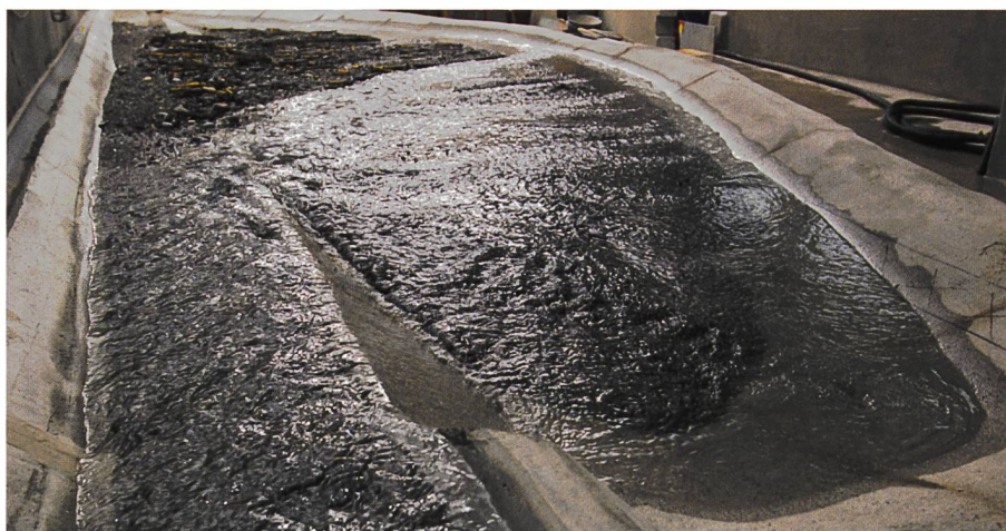
Bild 7. Ansicht in Fliessrichtung des Geschiebesammlers und Streichwehrs im physikalischen Modell. Fächerartige Ausbreitung der Ablagerungen im oberen Teil des Sammlers (Quelle: VAW).
