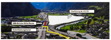
Bild 7. Überlastkorridor Reuss im Gebiet Schachen-Schattdorf oberhalb der Schächenmündung mit Notentlastungskanal für die «Stille Reuss».
