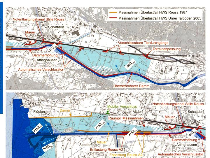
Bild 2. Überlastfall Reuss im Talboden: Massnahmen nach Hochwasser Reuss 1987 (realisiert 1996 bis 2000) und Massnahmen im Rahmen Hochwasserschutz Urner Talboden (realisiert 2010 bis 2016): Bild oben: Erstfeld bis Attinghausen. Bild unten: Attinghausen bis Flüelen.
