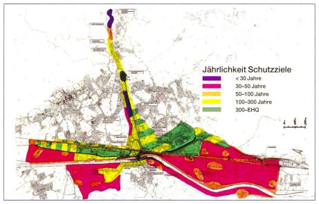
Bild 2. Schutzziele für den «Urner Talboden» gemäss Schutzzielmatrix mit erhöhter Schadensgrenze Q<sub>2</sub> in sensiblen Gebieten.
