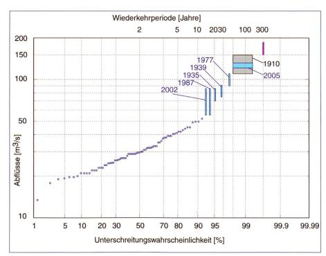
Bild 2. Frequenzdiagramm des Schächens beim Pegel in Bürglen (108.5 km²) aus den Jahreshochwassern von 1926–2006 (blau). Zwischen 1930 und 1985 befand sich der Pegel in Bürglen (94 km²). Zusätzlich eingetragen sind das abgeschätzte Hochwasser von 1910 und die Resultate der Modellrechnungen (violett).
