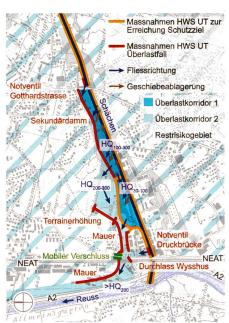
Bild 1. Überlastfall Schächen: Massnahmen und Abfluss- und Geschiebeablagerungsprozess.
