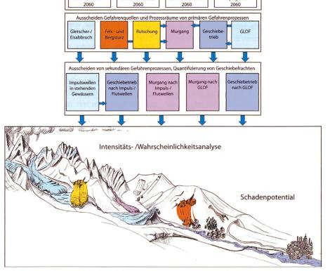
Bild 1. Verschiedene primäre und sekundäre Naturgefahrenprozesse welche durch den Klimawandel im alpinen Raum verstärkt werden können. Die Figur zeigt die generelle Verknüpfung der einzelnen Prozesse (GLOF = Glacier Lake Outburst Flood/Gletscherseeausbruch) [3].
