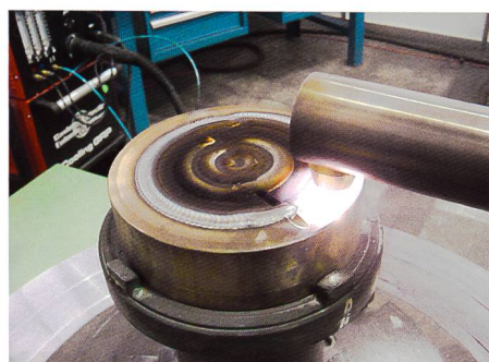
Bild 3. Versuchsplatte mit PTA geschweisst.
