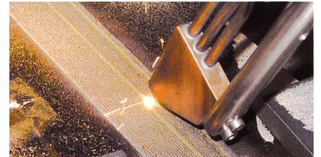
Bild 5. Flächiges Auftragsschweissen mit einer Off-Axis-Düse.
