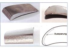
Bild 6. Segment einer Dampfturbinenschaufel mit Stellite-Schutzschicht gegen Wassertröpfchenerosion an der Schaufelvorderkante.
