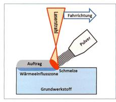
Bild 4. Verfahrensprinzip Laserauftragsschweissen.
