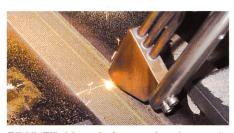
Bild 5. Flächiges Auftragsschweissen mit einer Off-Axis-Düse.
