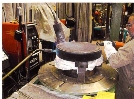
Bild 2. Verfahren WIG mit Fülldraht.
