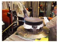
Bild 2. Verfahren WIG mit Fülldraht.
