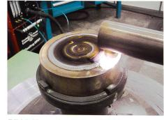
Bild 3. Versuchsplatte mit PTA geschweisst.
