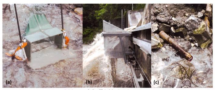
Bild 2. (a) Erfassung des Austrags von Stücken organischen Materials mittels Geschiebefangnetzen im Erlenbach bei leicht erhöhtem Abfluss (Schneeschmelze, 2. April 2012); (b) ein automatischer Geschiebefangkorb steht bei mittlerem Abfluss im Einsatz (29. Juli 2010); (c) mit RFID-Sender ausgerüstetes Holzstück der Längenklasse 0.5 m im Bachbett des Erlenbaches.
