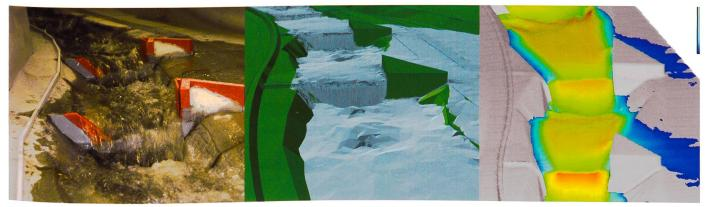
Bild 8. Abfluss von 85 m³/s, hydraulisches Modell, 2-D-Modell, 3-D-Modell.
