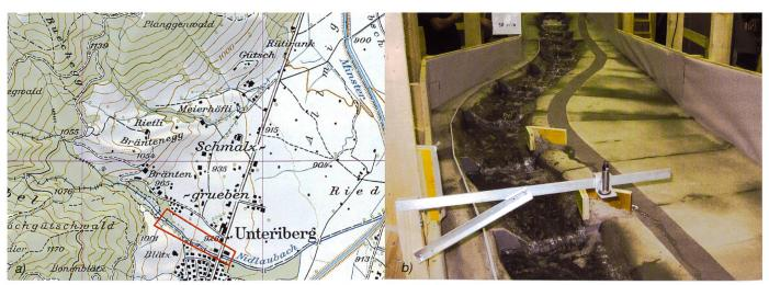
Bild 3. Links: Rot markierter Modellperimeter, rechts: Ausleitstrecke mit Leitspornen.
