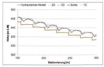
Bild 4. Verlauf des Wasserspiegels entlang der Ausleitstrecke.
