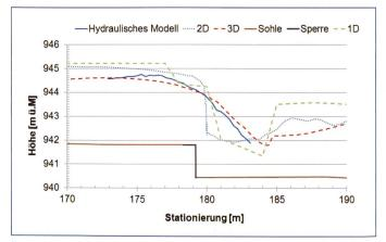
Bild 5. Detail der Senkungskurve bei der Sperre Nr. 28.
