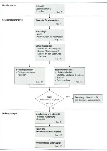
Bild 3. Genereller Ablauf zur Beurteilung der Gefahr von Ufererosion.
