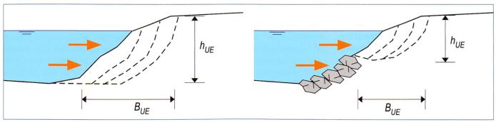
Bild 5. Ufererosion durch direkten Strömungsangriff.
