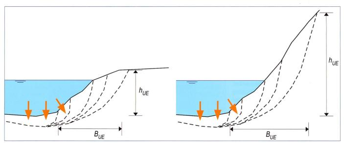
Bild 4. Sohlenerosion, Kolkbildung oder die Erosion des Böschungsfusses destabilisieren die Böschung (links bei niedriger Böschung, rechts bei hoher Böschung). Bedeutung der Bezeichnungen siehe Bild 7.
