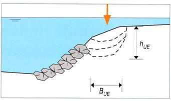
Bild 6. Erosion an der Böschungsoberkante.
