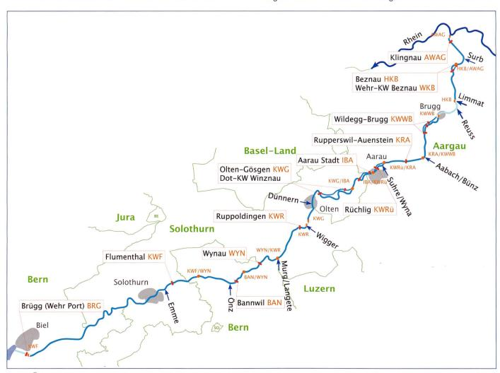
Bild 2. Übersichtsplan der Aare vom Bielersee bis zur Mündung in den Rhein. Die Standorte der wichtigsten Zuflüsse sind mit blauen Pfeilen markiert. Praktisch der gesamte Flusslauf wird von den Konzessionsstrecken der 12 Wasserkraftwerke geprägt (Quelle: Flussbau AG, Bern).
