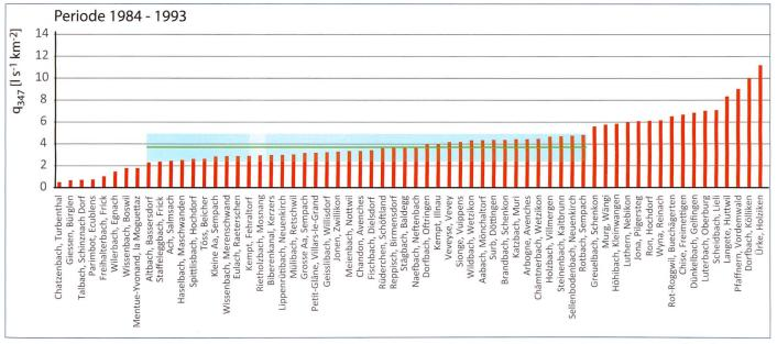
Bild 6. Die Mehrzahl der Q<sub>347</sub>-Abflüsse (Messreihen 1984–93) liegt im schweizerischen Mittelland zwischen 2 und 5 l s<sup>-1</sup> km<sup>-2</sup> mit einem Mittelwert von 3.6 l s<sup>-1</sup> km<sup>-2</sup> (grüne Linie). Einige der Gebiete mit höheren Q<sub>347</sub> liegen in der von Sandstein dominierten Molasse.
