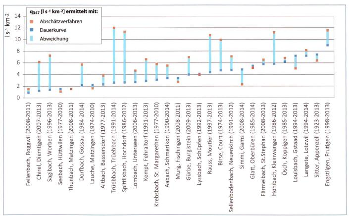
Bild 1. Aus Messreihen und nach Aschwanden & Kan (1999) hergeleitete spezifische Q<sub>347</sub> [I s<sup>-1</sup> km<sup>-2</sup>] für 29 zufällig ausgewählte Einzugsgebiete. Bei rund der Hälfte der Gebiete treten grössere Abweichungen auf. Die ausgewählten Gebiete wurden nicht für die Herleitung der Regressionsgleichungen verwendet.
