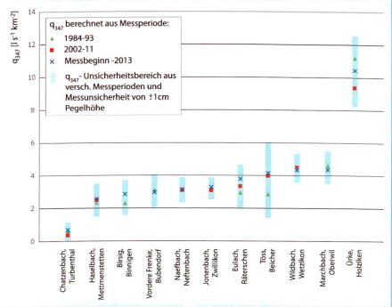
Unsicherheiten in der Bestimmung des Q<sub>347</sub> bestehen auch bei gut gewarteten Pegeln. Dargestellt sind Auswirkungen von unterschiedlichen Messperioden auf das Q<sub>347</sub> und der Bereich, der durch Messfehler des Pegelstandes von einem Zentimeter resultiert.
