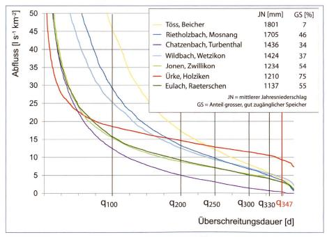
Bild 5. Die Dauerkurven der dargestellten Mittelland-Einzugsgebiete (Periode 2002–2011; AWEL 2012; BAFU 2012, Hydrometrie Aargau 2012) werden bis zum  $\mathbf{Q}_{200}$  vom Niederschlag und der Drainage aus den kartierten Speichern dominiert. Über dem  $\mathbf{Q}_{300}$  werden Speicher mit geringer Durchlässigkeit massgebend.
