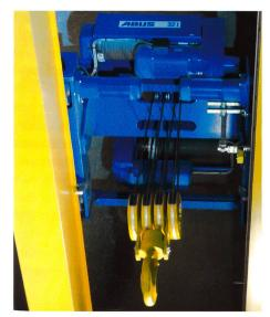
Bild 4. Die ABUS-Laufkatze mit einer Hubleistung von 2.4/15.1 kW und einer Fahrleistung von 2 × 0.14 / 0.65 kW ist zweistufig polschaltbar 5/20 m/min.
