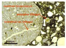
Bild 6. Bei der Alkali-Aggregat-Reaktion (AAR) wird amorphes Silika im alkalischen Porenwasser zunächst gelöst und dann als kristallisiertes Silika-Gel ausgeschieden. (Foto: TFB-Bulletin).
