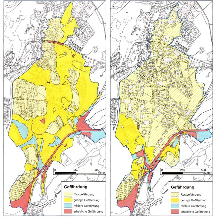
Bild 8. Gefahrenkarte vor Realisierung (links) und nach Realisierung der Massnahmen der 1.-3. Etappe (rechts).
