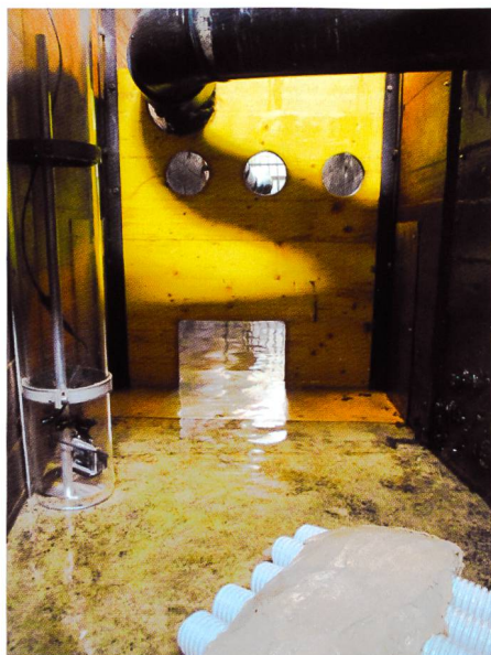
Bild 4. Aufbau des Fischtreppeversuchs von 2014: links die GoPro zur Überwachung des Durchganges. Im Vordergrund sind die künstlichen Verstecke zu sehen.
