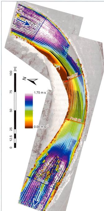
Bild 5. Zeitlich gemitteltes Feld der Oberflächenströmung in einer Rasterauflösung von 1.0×1.0 m² und 50% Überlappung, entsprechend einem Vektorabstand von 0.5 m, sowie Stromlinien.
