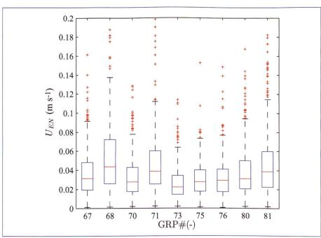
Bild 4. Exemplarische Whiskerplot-Darstellung der verbleibenden Versatzgeschwindigkeiten  $U_{EN}$  für alle im Video zum Flug M2T1 detektierten GRP; horizontale (rote) Linie = Median, (blaue) Box = 25- und 75-Perzentile, (schwarze) Whiskers = Extremwerte, (rote) Pluszeichen = Ausreisser.
