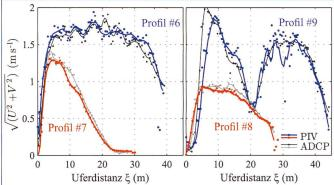
Bild 6. Vergleich von Geschwindigkeitsprofilen aus 3D-ACDP Messung in den obersten 0.25 m der Strömung und Airborne PIV (Punkte: Rohdaten, Linien: geglättet mit Savitzky-Golay Filter); Lage der Profile: siehe Bild 5.
