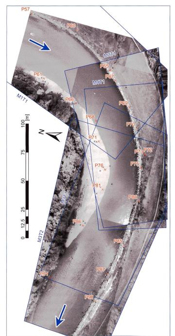
Bild 1. Untersuchungsbereich, mit am Ufer liegenden GRP (rotes x = Messung mit Leica GPS 1200, schwarzes x = einzelne, über den Tag verteilte Handmessungen mit Garmin eTrex) und fünf charakteristischen Einzelbildfeldern aus verschiedenen Messflügen (blaue Umrandung).
