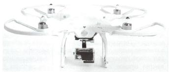
Bild 2. Quadrokopter DJI Phantom FC40 mit montierter 4K-Kamera GoPro Hero3+ Black-Edition (Orientierungsrichtung zum Boden, inkl. wasserdichtem Schutzgehäuse).
