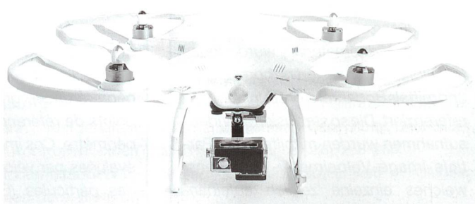
Bild 2. Quadrokoopter DJI Phantom FC40 mit montierter 4K-Kamera GoPro Hero3+ Black-Edition (Orientierungsrichtung zum Boden, inkl. wasserdichtem Schutzgehäuse).
