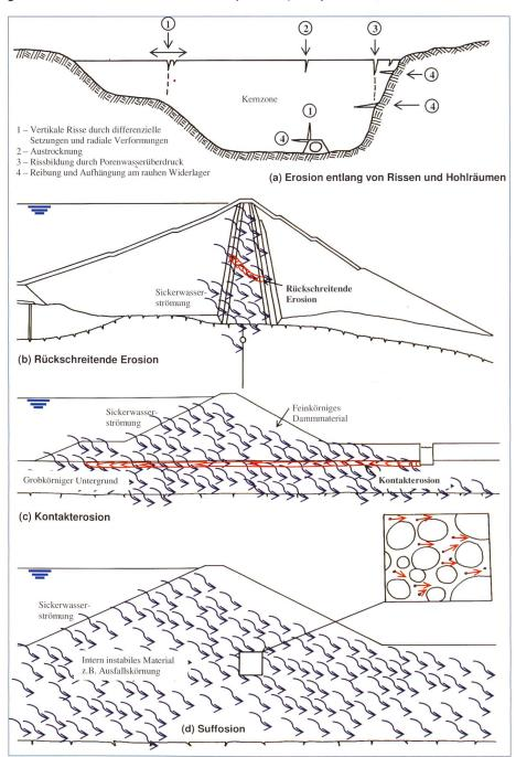
Bild 4. Mechanismen der inneren Erosion.
