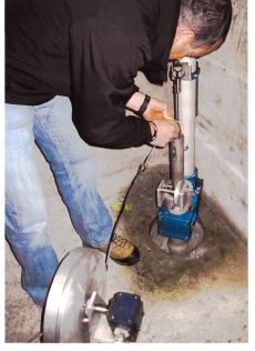
Figura 3. Lettura degli strumenti di controllo nello sbarramento.
