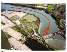
Bild 1. Luftbild zur grossräumigen Anströmung des Maschinenhauses KRS (Bild Kraftwerk Ryburg-Schwörstadt AG).
