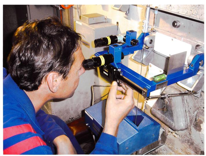
Barragiste en train de faire une mesure de pendule. / Dam warden taking a plumb line measurement.
