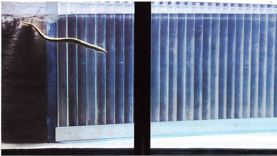
Bild 5. Aal vor der Leiteinrichtung im Modell an der VAW-ETHZ (Foto: David Flügel).
