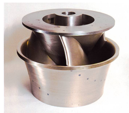
Bild 4. Modell der fischfreundlichen Alden-Turbine. Das Modell wird von Voith Hydro für hydraulische und betriebliche Tests verwendet (Foto: Alden Research Lab).
